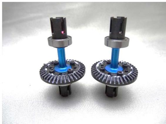
・リヤとフロントギヤケースを分解し、中に組み込まれているデフギヤと組立てたダイレクトカップリングを取出し、組立てたダイレクトカップリングに交換します
