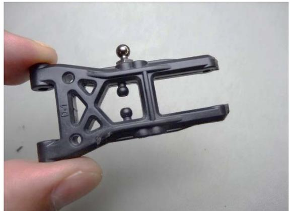
・フロントアクスルの部品を取外し、リヤクスルと同じ部品に交換します
