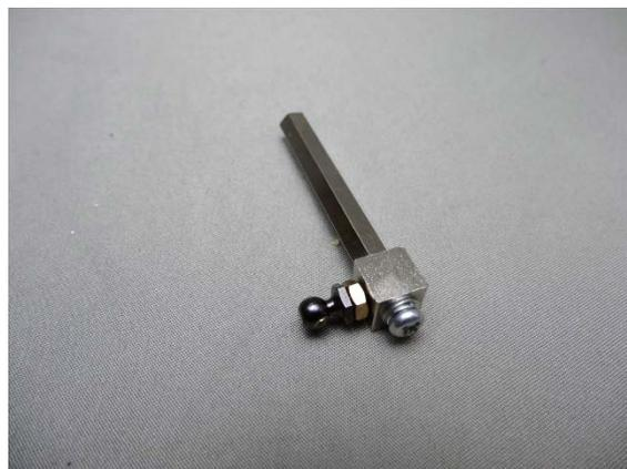
・角スペーサ(20 ミリ)、ピローボールによりアッパーアーム取付け用の支柱を組立てます(2個)
