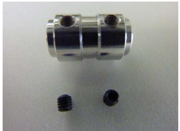
・出来上がったプロペラシャフトの両端のピンの間の距離が95mm以上だと、アルミシャーシに組み込めないので注意してください(90~95ミリであれば組込めます)
