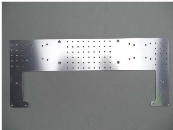
注 意：・左右が対象でない、四角い穴が3つ開いているほうが駆動輪シャーシで、モーター、ギヤケースなどを取付け、また左右対称なほうが従動輪シャーシで、ブレーキサーボ、バッテリー、受信機、小型ESC、スイッチなどを取付けます
