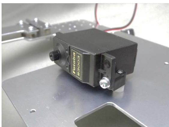
注意：・駆動輪側シャーシのちょうどモーターの裏側にあたる位置で、モーターを取付けてからでは取付けられないので、先に取付けます
